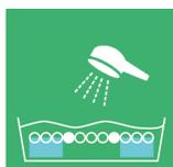
Dopo l'esposizione bagnare internamente ed esternamente il quadro, lasciare il quadro bagnato per qualche istante e sciacquare successivamente con getto d'acqua sul lato stampa fino alla completa apertura dei dettagli del disegno. Se possibile, si consiglia di immergere il quadro in acqua a temperatura ambiente per circa cinque minuti prima dello sviluppo.
